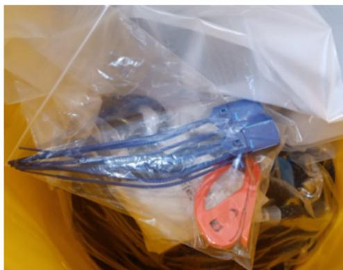
6) L'état de l'emballage doit être vérifié, il doit être emballé sous vide et ne doit pas être perforé ou présenter des signes de meurtrissure, sinon il doit être envoyé à l'usine ou autorisé pour inspection.
