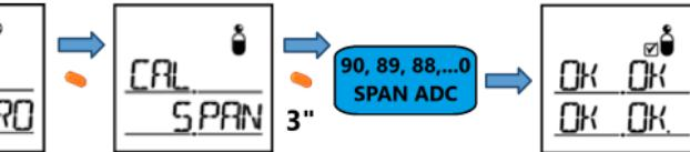
Hvis kalibreringen mislykkes, vises FA (Fail) i stedet for OK på LCD-skjermen. Trykk på knappen for å gå inn i den første friskluftkalibreringsmodulen, og hvis du ikke trykker på knappen, bytter du til målmodus. Hvis FA fortsetter, må du kontakte IRUDEK eller butikken der du kjøpte apparatet, da det kan være nødvendig å skifte ut sensorene eller reparere apparatet.
