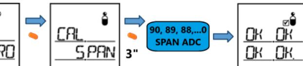
Si la calibración falla, la frase FA (Fail), en vez de OK, aparece en la pantalla LCD. Presione el botón para ingresar al modo de calibración de aire fresco inicial y, si no presiona el botón, cambia al modo de medición. Si FA continúa, consulte con IRUDEK o la tienda que compró, ya que puede requerir el reemplazo del sensor o la reparación del dispositivo.
