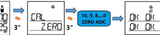
Si la calibración falla, aparece FA (Error), en vez de OK, en la pantalla LCD. Presione el botón para ingresar al modo de calibración de aire fresco inicial y cambiará al modo de medición si no presiona el botón durante 3 segundos. Si FA continúa, consulte con IRUDEK o la tienda que compró, ya que puede requerir el reemplazo del sensor o la reparación del dispositivo.
