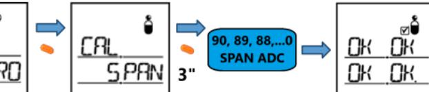
Ha a kalibrálás sikeresen, az LCD kijelző OK felüli FA (Fail) jelentik meg. Nyomja meg a gombot a kezdeti frissítésig-kalibrálási üzemmódba való belépéshez, és ha nem nyomja meg a gombot, akkor mérési üzemmódba vált. Ha a FA továbbra is fennáll, forduljon az IRUDEK-hez vagy a beszerző üzethez, mivel szükség lehet az érzékelő cseréjére vagy a készülék javítására.
