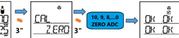
Se a calibração falhar, FA (Error), em vez de OK, será exibido no LCD. Pressione o botão para entrar no modo de calibração inicial de ar fresco e passará para o modo de medição se o botão não for pressionado por 3 segundos. Se o FA continuar, consulte a IRUDEK ou a loja de compra, pois pode ser necessária a substituição do sensor ou o reparo do dispositivo.
