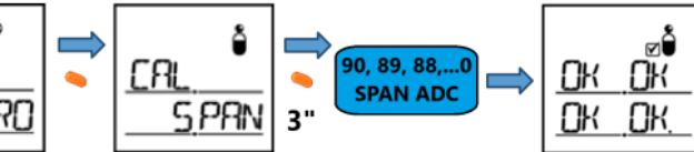
Dacă calibrarea eșuează pe ecranul LCD apare FA (Fail), în loc de OK. Apăsați butonul pentru a intra în modul de calibrare inițială și așezați aerul proaspăt și, dacă nu apăsați butonul, treceți la modul de măsurare. Dacă FA continuă, consultați IRUDEK sau magazinul de achiziție, deoarece poate fi necesară înlocuirea senzorului sau repararea dispozitivului.
