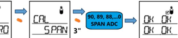
Si l'éclairage échoue, l'écran LCD affiche FA ('fail') au lieu de OK. Appuyez sur le bouton pour entrer dans le mode d'étalonnage initial de l'air frais et, si vous n'appuyez pas sur le bouton, passez au mode de mesure. Si l'échec persiste, consulter IRUDEK ou le magasin d'achat, car le remplacement du capteur ou la réparation de l'appareil peut s'avérer nécessaire.
