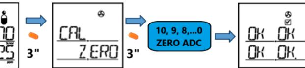
Ak kalibrácia zlyhá, na LCD displeji sa namiesto OK zobrazí FA (Chyba). Stlačením tlačidla vstúpte do režimu počiatocnej kalibrácie čerstvého vzduchu a ak tlačidlo nestlačíte po dobu 3 sekúnd, prepne sa do režimu merania. Ak FA pretrváva, obráťte sa na spoločnosť IRUDEK alebo na predajhu, kde ste výrobok zakúpili, pretože môže byť potrebná výmena súmiera alebo oprava zariadenia.
