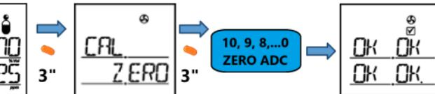
Wenn die Kalibrierung fehlgeschlägt, erscheint auf dem LCD-Anzeige nicht OK, sondern FA (Fehler). Drücken Sie die Taste, um den anfänglichen Frischluftkalibrierungsmodus aufzurufen, und wechseln Sie in den Messmodus, wenn die Taste 3 Sekunden lang nicht gedrückt wird. Wenn FA weiterhin angezeigt wird, wenden Sie sich an IRUDEK oder an das Geschäft, in dem Sie das Gerät gekauft haben, da ein Austausch des Sensors oder einer Reparatur des Geräts erforderlich sein kann.
