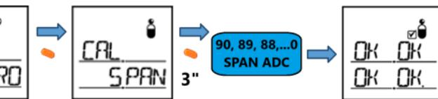
Wenn die Kalibrierung fehlgeschlagen ist, erscheint FA (Fehler) anstelle von OK auf der LCD-Anzeige. Drücken Sie die Taste, um den anfänglichen Frischluftkalibrierungsmodus aufzurufen, und schalten Sie, wenn Sie die Taste nicht drücken, in den Messmodus um. Wenn FA weiterhin angezeigt wird, wenden Sie sich an IRUDEK oder an das Geschäft, in dem Sie das Gerät gekauft haben, da ein Austausch des Sensors oder eine Reparatur des Geräts erforderlich sein kann.
