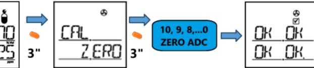
Se la calibrazione non va a buon fine, sul display LCD appare FA (Error), invece di OK. Premere il pulsante per accedere alla modalità di calibrazione iniziale dell'aria fresca e passare alla modalità di misurazione se non si preme il pulsante per 3 secondi. Se FA continua, consultare IRUDEK o il negozio di acquisto, poiché potrebbe essere necessaria la sostituzione del sensore o la riparazione del dispositivo.
