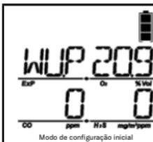
Uma vez ativado, o dispositivo entrará na fase de aquecimento para estabilizar os sensores.
