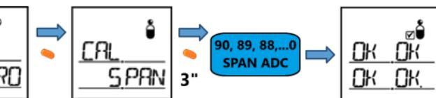
Se a calibração falhar, aparece 'FA (Fail)', em vez de 'OK', no ecrã LCD. Premir o botão para entrar no modo de calibração inicial de ar fresco e, se não premir o botão, passar para o modo de medição. Se o FA continuar, consultar a IRUDEK ou a loja de compra, uma vez que poderá ser necessário substituir o sensor ou reparar o dispositivo.
