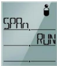
A nullázás vagy kalibrálás aktiválásához nyomja meg a bekapcsológombot. Nullázás (friss levegő kalibrálás): nulla kalibrálás
