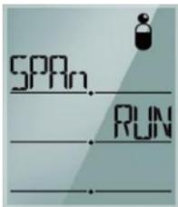
Função de calibração de span
