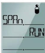
Funcția de calibrare Span
